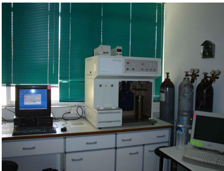
Slika 20. – Sorptomatic 1990 Thermo Finnigan uređaj za karakterizaciju specifične površine i poroznosti materijala
